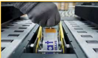
Unterer Klebekopf werkzeuglos entnehmbar!
